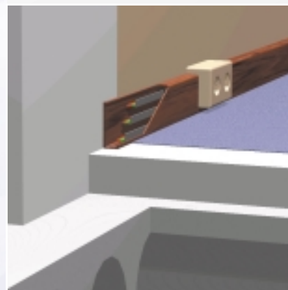
FIGUUR 4: GECOMBINEERDE PLINTGOOT
