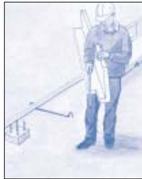
3. Plaats de EPS-bekistingselementen langs houten regels 45 x 70 mm
